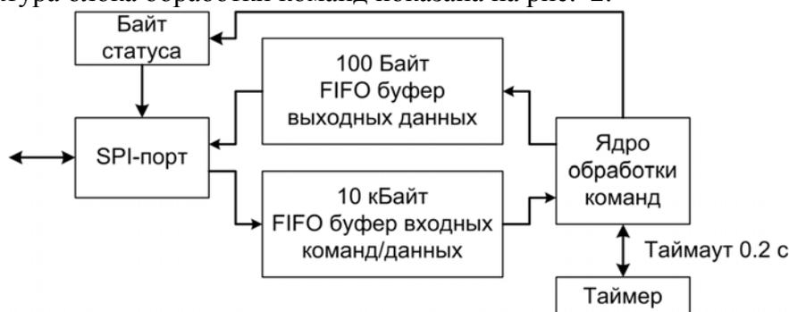
Рис. 2. Структура блока обработки команд
